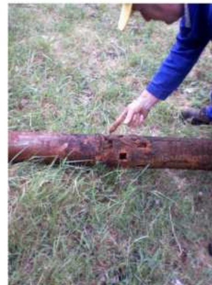
9. kép búvárszivattyú vas-kirakódással
